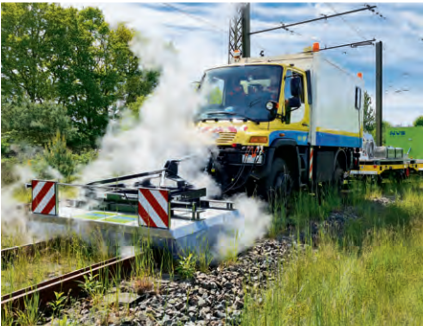
Die thermische Unkrautbekämpfung basiert auf dem einfachen Prinzip, dass weiches pflanzliches Gewebe abstirbt, sobald es Temperaturen deutlich über 42 °C erreicht
