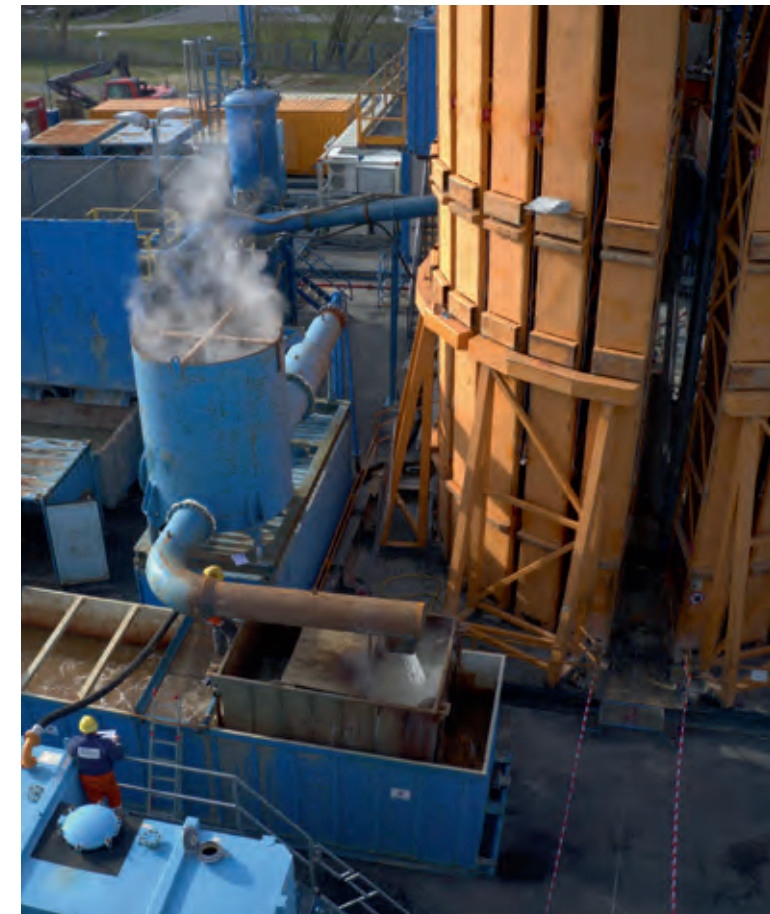
Der Dampf der gerade geförderten Thermalsole ist hier gut sichtbar
